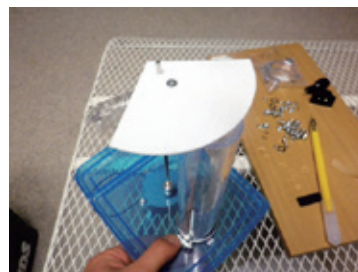
シンクロナスモーターと金属製の軸を組み立てている。軸に扇形の板を組み立てた。扇形の板は1mm厚のプラスチック板で電子パーツ店の姉妹店のデジットで購入した
