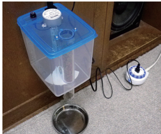
自動給餌器。時間になるとプラスチックケース内にセットした扇形の板が稼働し、猫用ドライフードがエサ皿に落ちる
